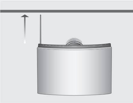
Achten Sie auf ausreichend Freiraum über dem BeoSound 1 für die eingebaute Antenne und das CD-Fach.
